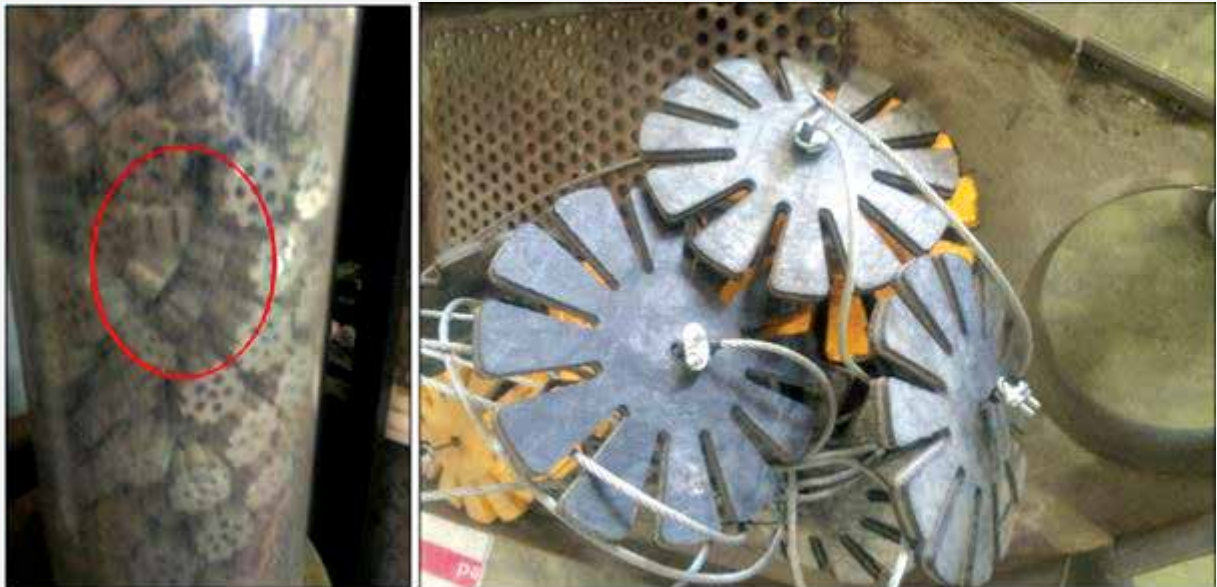
شکل ۵: پره های لاستیکی کاهنده سرعت در روش بارگذاری سنتی - حفرات بوجود آمده پس از شارژ کاتالیست ریفرمینگ احیاء مستقیم (شکل سمت چپ)
