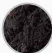
پاترکس (پودر پوشاننده سطح مذاب در پاتیل و تاندیش)
