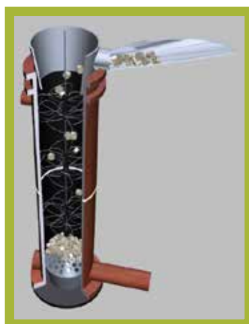
شکل ۱: روش بارگذاری متراکم یکنواخت: سمت راست (بارگذاری مخازن سولفورز دایی)، سمت چپ (بارگذاری تیوب های ریفرم)
