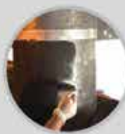
الکوات (پوشش الکترود گرافیتی جهت کاهش ضریب مصرف)
