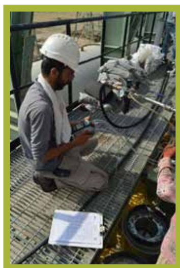
شکل ۴: تست افت فشار دو سر تیوب ها
